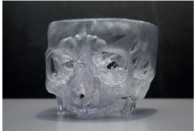
Bild 4. SLA-Modell eines Gesichtsschädels zur OP-Vorbereitung
