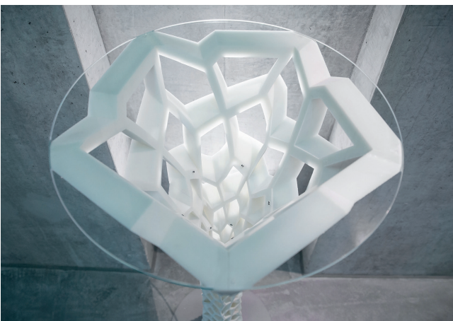
Bild 9. Der Standfuß des Designertisches besteht aus 60 lasergesinterten Einzelteilen, die miteinander verschweißt wurden © FIT AG/Lisa Kirk
