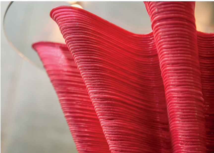
Bild 12. Per Robotic FDM hergestellter Designtisch © FIT AG/Lisa Kirk
