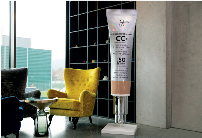
Bild 3. Fertig gefinishte Werbeplastik für L'Oréal mit GDP-Korpus, der durch Photopolymerisation eines hochviskosen Gels erzeugt wurde
